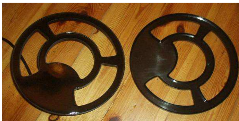
Sonda (widok od spodu) oraz osłona
